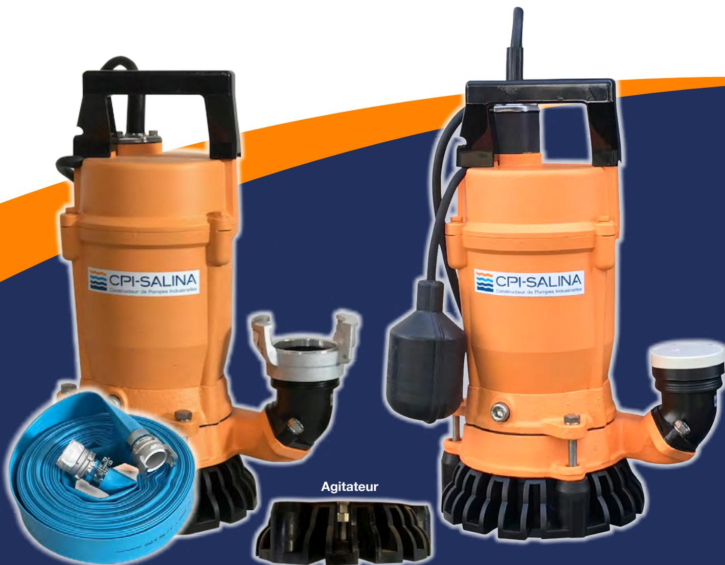
**Pompes submersibles de chantier avec agitateur et roue semi-vortex, destinées au relevage d'eaux chargées, boueuses et sableuses. Elles sont équipées d'une double garniture mécanique à bain d'huile.**
